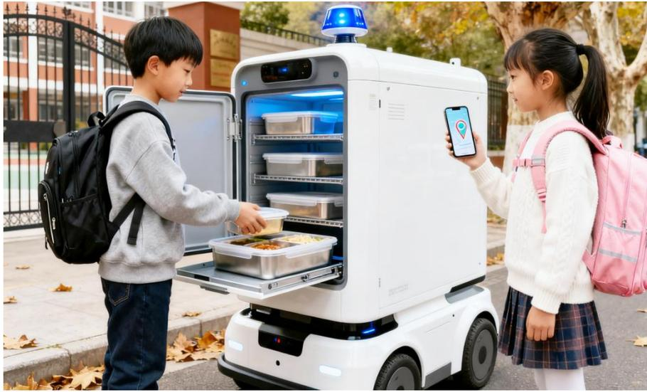
机器人的餐箱采用分层保温结构，热菜区域能保持 60-70℃ 的恒温，凉菜区域则维持 5-10℃ 的低温，确保火烧酥脆、热菜温热；它还搭载了 AI 导航系统，能实时分析路况，避开拥堵路段，比如在石家庄市配送时，会优先选择非机动车道和畅通的小路，缩短配送时间。此外，顾客可以通过手机实时查看机器人的位置，到达后凭取餐码就能取餐，让美味无需久等。
