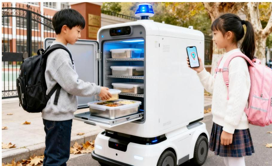
机器人的餐箱采用分层保温结构，热菜区域能保持 60-70℃ 的恒温，凉菜区域则维持 5-10℃ 的低温，确保火烧酥脆、热菜温热；它还搭载了 AI 导航系统，能实时分析路况，避开拥堵路段，比如在石家庄市区配送时，会优先选择非机动车道和畅通的小路，缩短配送时间。此外，顾客可以通过手机实时查看机器人的位置，到达后凭取餐码就能取餐，让美味无需久等。
