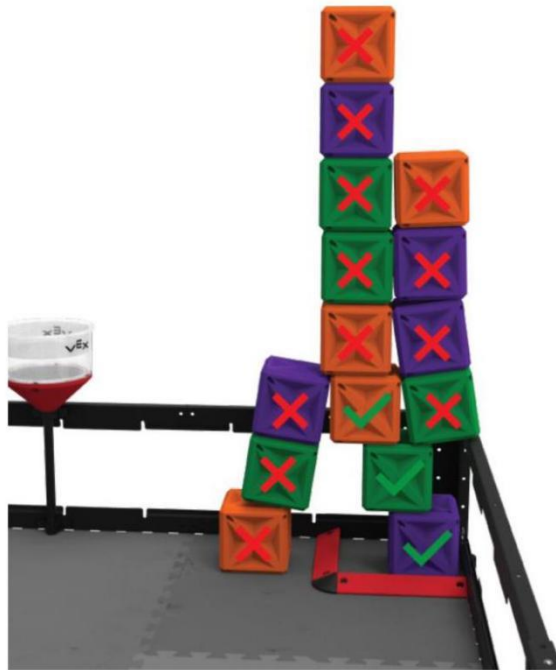
图12 目标区中得分方块（绿色对号）和不得分方块（红色错号）的实例 不得分的原因是这些方块接触了不得分方块的顶面
